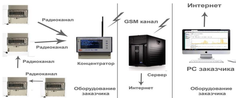
Рис. 1 Схема сбора данных системы АСКУЭ.
